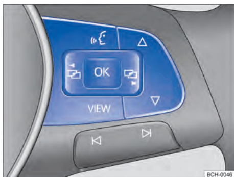
Fig. 15 Lado derecho del volante multifunción (variante 1): teclas para el mando de los menús y visualizaciones de información del instrumento combinado.
