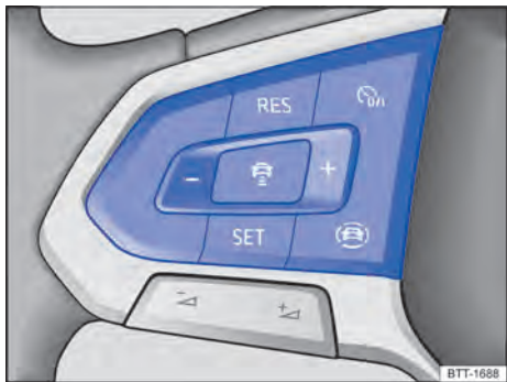
Fig. 110 Lado izquierdo del volante multifunción: teclas para mando del ACC. (variante 1)
