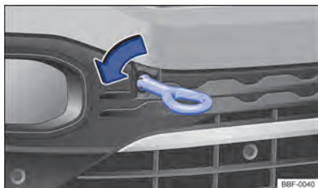
Fig. 167 En el parachoques delantero a la derecha: enrosque la argolla de remolque.
