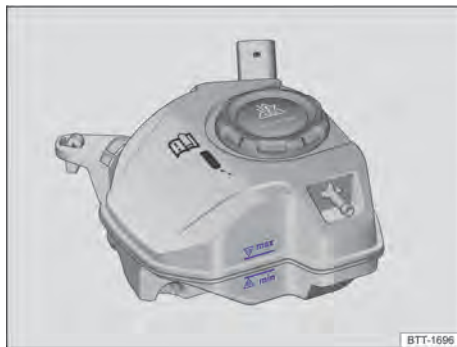
Fig. 174 En el compartimento del motor: marca en el depósito de expansión del líquido refrigerante del motor.
