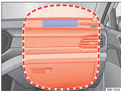
Fig. 33 Ubicación y radio de expansión del airbag frontal del acompañante.
