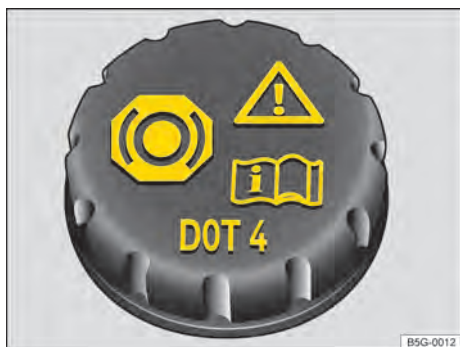
Fig. 176 En el compartimento del motor: tapón de cierre del depósito del líquido de frenos.
