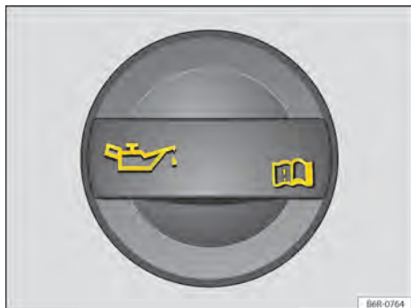
Fig. 173 En el compartimento del motor: tapón de la boca de llenado del aceite del motor.
