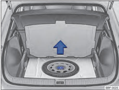
Fig. 151 En el maletero, por debajo del revestimiento del piso: rueda de emergencia y herramientas de a bordo.
