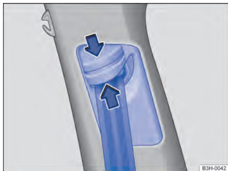
Fig. 30 Junto a los asientos delanteros: regulador de la altura del cinturón de seguridad.
