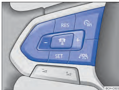
Fig. 111 Lado izquierdo del volante multifunción: teclas para mando del ACC. (variante 2)
