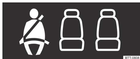
Fig. 20 Indicador de estatus del cinturón de seguridad para los asientos traseros en el display del instrumento combinado.
