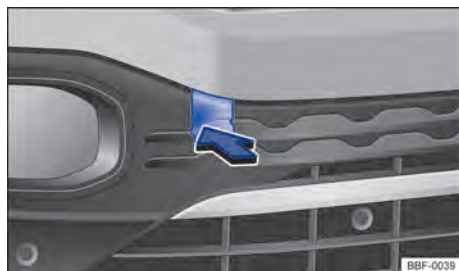
Fig. 166 En el parabrisas delantero a la derecha: suelte y desmonte la cubierta.
