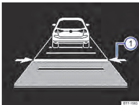
Fig. 112 En la pantalla del cuadro de instrumentos: ajustar la distancia (representación esquemática, el ACC regula).
