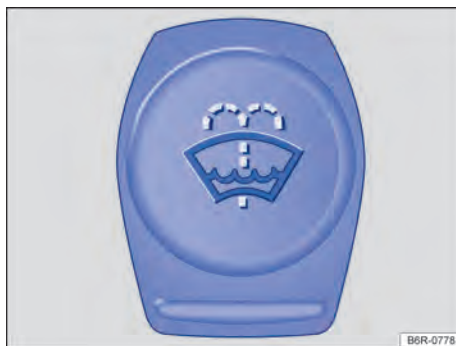
Fig. 171 En el compartimento del motor: tapón de cierre del depósito de agua de los lavacristales.
