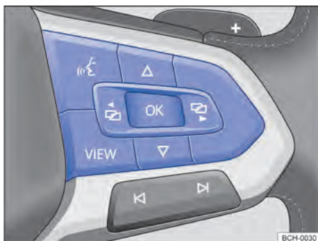
Fig. 16 Lado derecho del volante multifunción (variante 2): teclas para el mando de los menús y visualizaciones de información del instrumento combinado.
