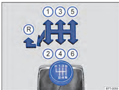
Fig. 95 Esquema de la transmisión manual de 6 marchas.
