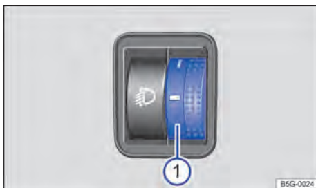
Fig. 74 Al lado del volante: regulador de alcance de las luces 1 .
