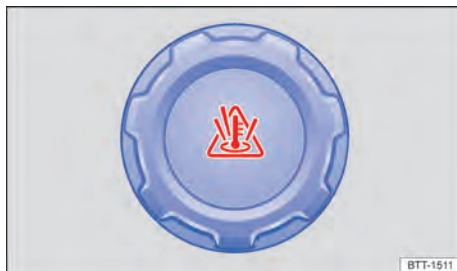
Fig. 175 En el compartimento del motor: tapa del depósito de expansión del líquido refrigerante del motor.
