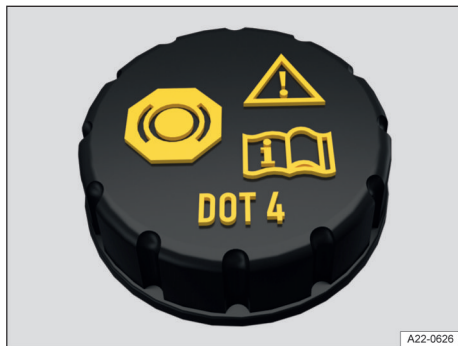
Fig. 173 En el vano delantero: tapa del depósito del líquido de frenos.
