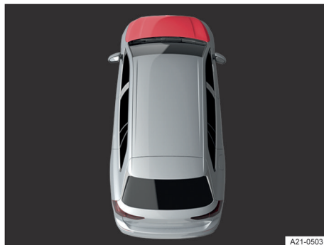
Fig. 165 En la pantalla del cuadro de instrumentos: capó delantero abierto o no cerrado correctamente (representación esquemática).
