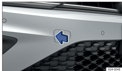
Fig. 154 En el lado derecho del paragolpes delantero: retirar la tapa, variante 1.
