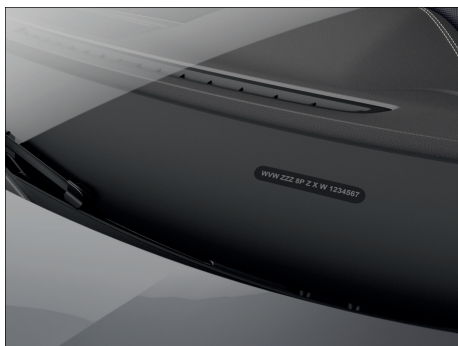
Fig. 208 En el parabrisas: número de identificación del vehículo.
