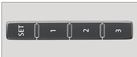
Fig. 74 En el lateral exterior del asiento del conductor: teclas de memoria.
