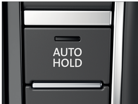
Fig. 118 En la consola central: tecla de la función Auto Hold.
