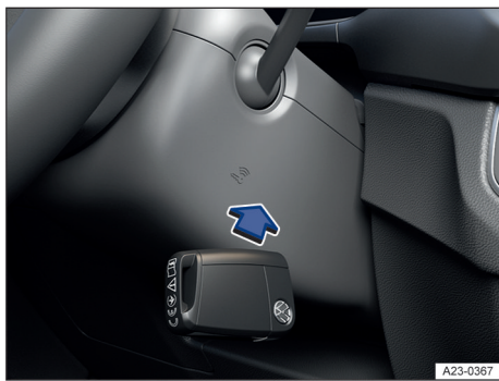
Fig. 92 En el lado derecho de la columna de dirección: función de arranque de emergencia en los vehículos con el sistema de cierre y arranque sin llave "Keyless Access" (representación esquemática).
