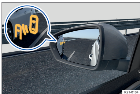
Fig. 116 En los espejos de los retrovisores exteriores: indicación del detector de ángulo muerto.
