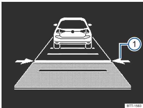
Fig. 112 En la pantalla del cuadro de instrumentos: distancia ajustada durante la regulación (representación esquemática).
