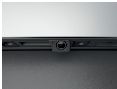
Fig. 203 En la parte trasera del vehículo: cámara de marcha atrás en la manilla con pulsador (representación esquemática).
