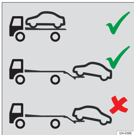
Fig. 153 Transportar con una grúa.
