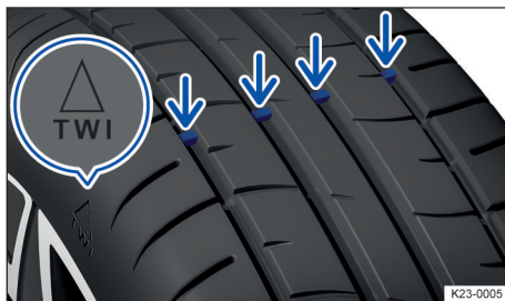
Fig. 180 En las acanaladuras del perfil: indicadores de desgaste.
