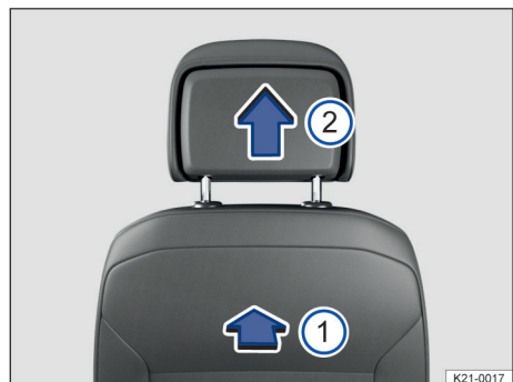
Fig. 68 Desmontaje de los apoyacabezas delanteros (representación esquemática).
