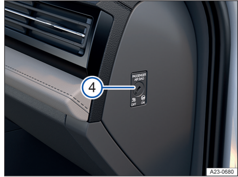
Fig. 8 Con la puerta del acompañante abierta (vehículos con el volante a la izquierda): conmutador de llave en el tablero de instrumentos (disposición simétrica en los vehículos con el volante a la derecha).
