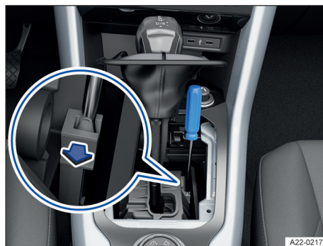
Fig. 99 En la consola central: realizar un desbloqueo de emergencia de la palanca selectora (variante 2).
