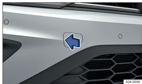
Fig. 155 En el lado derecho del paragolpes delantero: retirar la tapa, variante 2.
