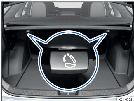
Fig. 64 En el maletero: palanca de desbloqueo desde el maletero.
