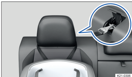
Fig. 39 En el respaldo del asiento trasero: colocación de la banda del cinturón de fijación superior (Top Tether) en forma de V si los apoyacabezas no se pueden ajustar.
