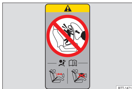
Fig. 35 En el pilar B: etiqueta adhesiva relativa al airbag (representación esquemática).
