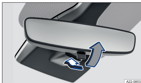
Fig. 84 En el parabrisas: retrovisor interior antideslumbrante manual.
