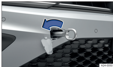
Fig. 156 En el lado derecho del paragolpes delantero: enroscar la argolla de remolque, variante 1.
