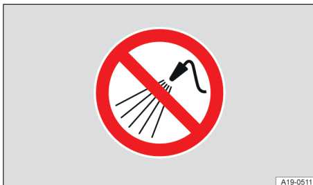
Fig. 201 En el vano delantero: no utilizar ningún equipo de limpieza de alta presión.
