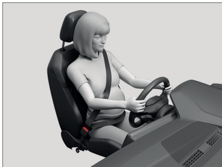
Fig. 26 Colocación correcta de la banda del cinturón en las mujeres embarazadas (representación esquemática).
