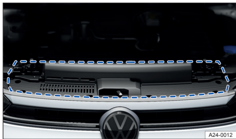
Fig. 167 Zona para el adhesivo relativo al aceite del motor (representación esquemática).
