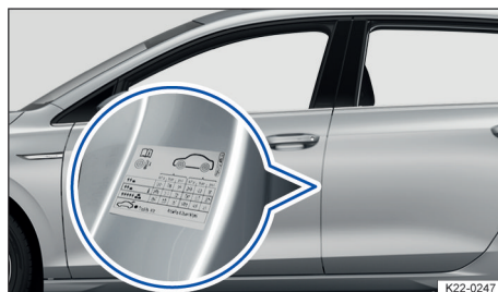
Fig. 177 En el pilar de la puerta del conductor: adhesivo de la presión de los neumáticos (o en la cara interior de la tapa del depósito de combustible).
