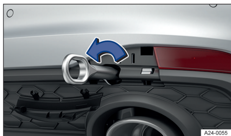
Fig. 161 En el lado derecho del paragolpes trasero: enroscar la argolla de remolque.
