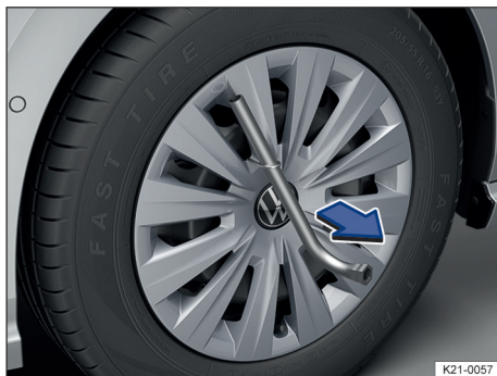
Fig. 183 Desmontar el tapacubos integral.
