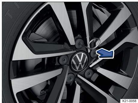
Fig. 184 Retirar las caperuzas de los tornillos de rueda.
