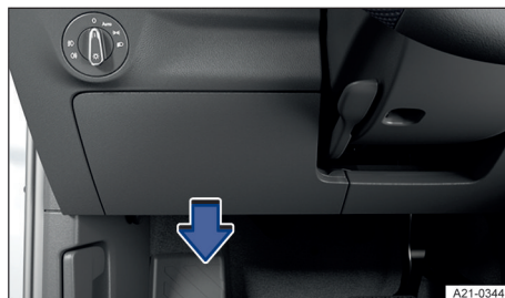
Fig. 147 En el lado izquierdo, junto al volante: tapa de la caja de fusibles del tablero de instrumentos.
