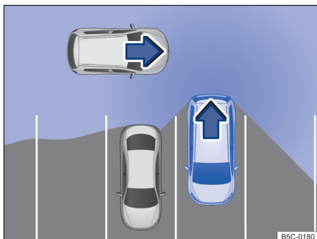
Fig. 122 Zona vigilada alrededor del vehículo que está desaparcando (representación esquemática).
