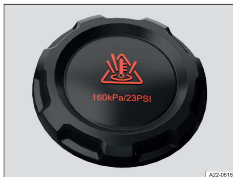
Fig. 171 En el vano delantero: tapa del depósito de expansión del líquido refrigerante (representación esquemática).
