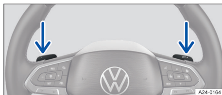
Fig. 97 Detrás del volante: levas de cambio para el Tiptronic (representación esquemática).
