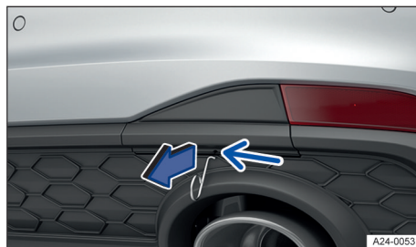
Fig. 160 En el lado derecho del paragolpes trasero: retirar la tapa.
