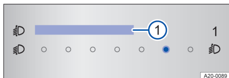
Fig. 80 En el sistema de infotainment: regulador táctil para la regulación del alcance de las luces.
