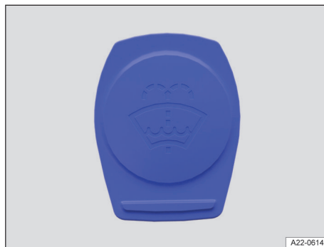
Fig. 166 En el vano delantero: tapa del depósito del líquido lavacristales (representación esquemática).
