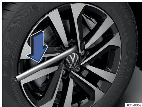
Fig. 185 Aflojar los tornillos de rueda.
