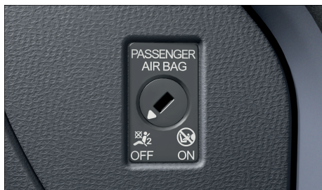
Fig. 29 En el tablero de instrumentos, en el lado del acompañante: conmutador de llave para desactivar y activar el airbag frontal del acompañante.
