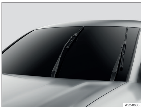
Fig. 142 Limpiacristales en posición de servicio (representación esquemática).
