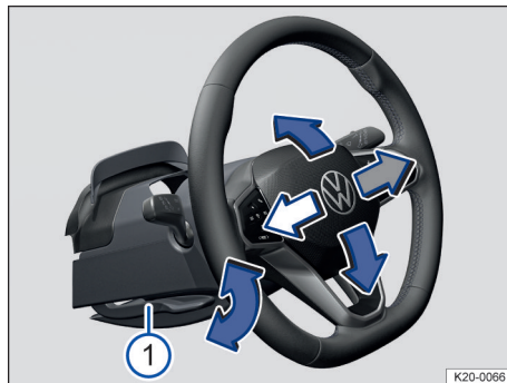
Fig. 59 Debajo del volante, en el guarnecido de la columna de dirección: palanca para el ajuste manual de la posición del volante (representación esquemática).
