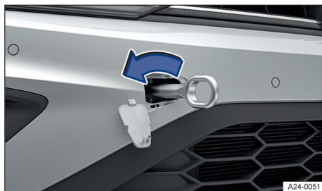
Fig. 157 En el lado derecho del paragolpes delantero: enroscar la argolla de remolque, variante 2.
