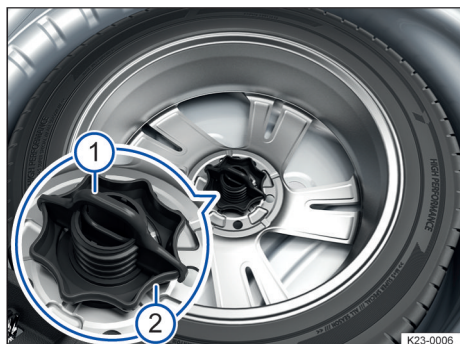
Fig. 182 Debajo del piso del maletero: ruedecilla para fijar la rueda de repuesto.
