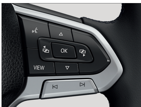
Fig. 12 Lado derecho del volante multifunción: manejo del cuadro de instrumentos digital Basic (representación esquemática).
