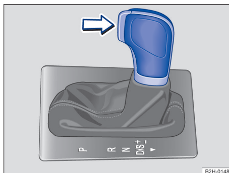
Fig. 102 Volante a la izquierda: bieleta de selección con tecla de bloqueo (flecha). En vehículos con volante a la derecha, la disposición de los elementos es espejada.
