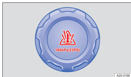
Fig. 188 En el vano motor: tapa del depósito de expansión del líquido refrigerante del motor.
