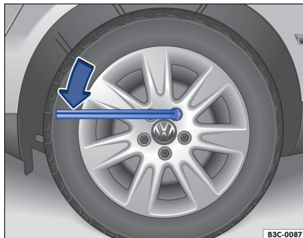
Fig. 201 Cambiar una rueda: aflojar los tornillos.
