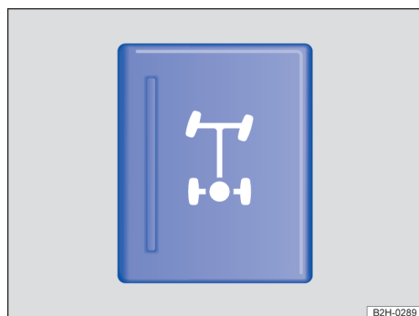
Fig. 111 En la consola central: tecla del bloqueo del diferencial (representación esquemática).
