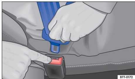
Fig. 31 Soltar la lengüeta del cierre del cinturón.
