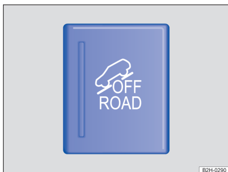
Fig. 107 En la consola central: tecla para conectar y desconectar manualmente la función Offroad.
