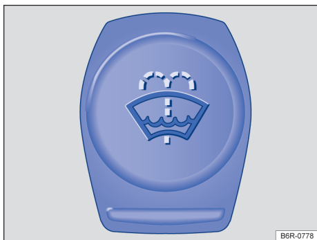
Fig. 183 En el vano motor: tapa del depósito del líquido limpiaparabrisas.
