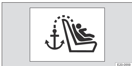
Fig. 53 Representación esquemática: distintivo del punto de fijación del cinturón Top Tether.
