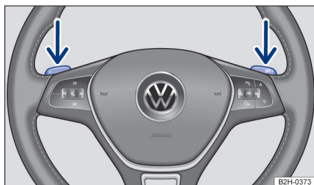
Fig. 104 Volante con conmutadores basculantes del Tiptronic.
