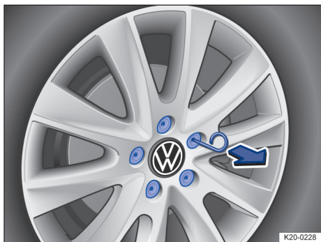
Fig. 200 Retirar las caperuzas de los tornillos de la rueda.
