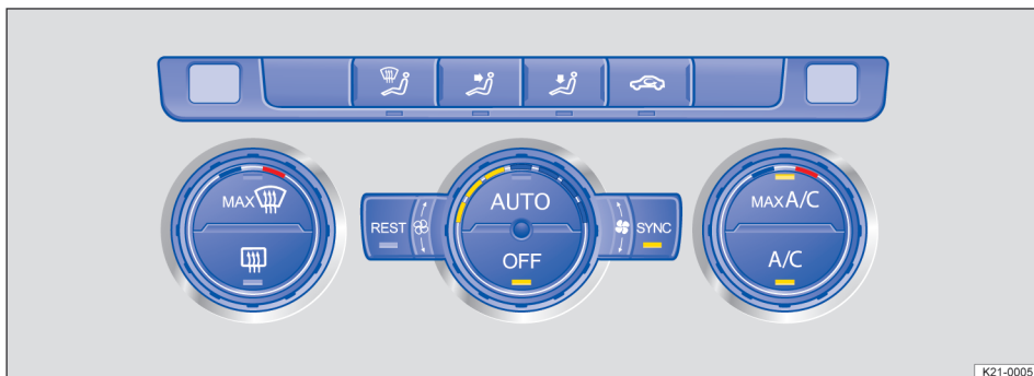
Fig. 96 En el tablero de instrumentos: mandos del Climatronic.
