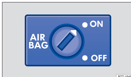
Fig. 42 En el lateral del tablero de instrumentos del lado del acompañante: conmutador de llave para desactivar y activar el airbag frontal del acompañante.
