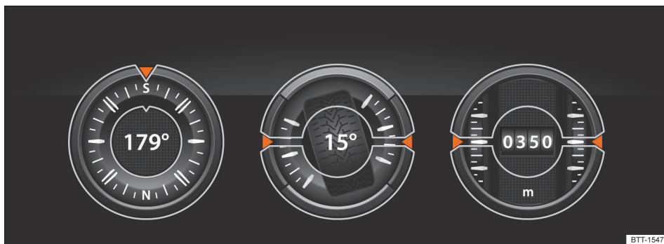
Fig. 109 En el sistema de infotainment: indicador Offroad.
