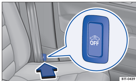
Fig. 59 Junto al asiento del conductor: tecla para desconectar la vigilancia del habitáculo y el sistema antirremolcado.
