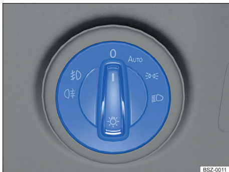
Fig. 81 Junto al volante: mando de las luces (una variante).
