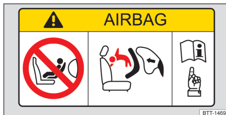
Fig. 47 Representación esquemática: etiqueta adhesiva relativa al airbag en el parasol.
