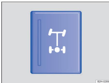
Fig. 102 En la consola central: tecla del bloqueo del diferencial (representación esquemática).
