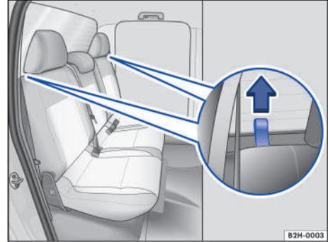
**Fig. 61** Asiento trasero: lazo para desbloquear el respaldo.
