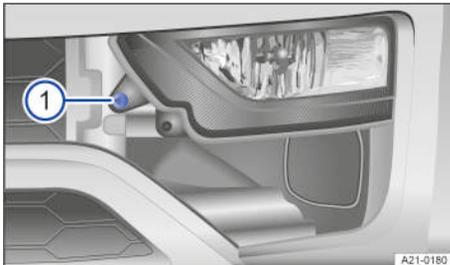
Fig. 148 En el paragolpes delantero: desmontar el faro.
