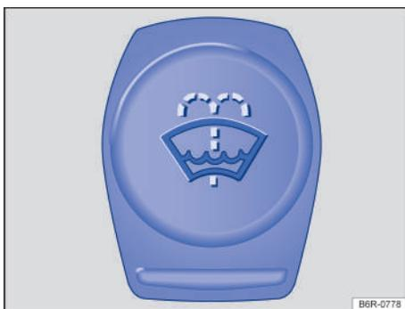
**Fig. 174** En el vano motor: tapa del depósito del líquido limpiaparabrisas.
