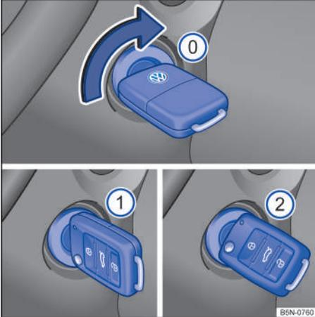
**Fig. 90** Junto al volante, en el lado derecho: posiciones de la llave del vehículo en la cerradura de encendido.
