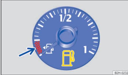
Fig. 14 Indicador del nivel de combustible en el cuadro de instrumentos analógico (representación esquemática).
