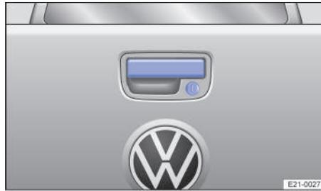
Fig. 50 En la compuerta de carga: manilla para abrir la compuerta de carga.
