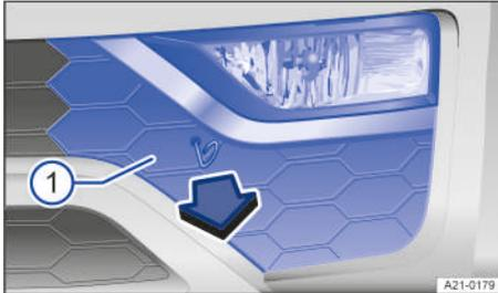
Fig. 147 En el paragolpes delantero: desmontar la cubierta.
