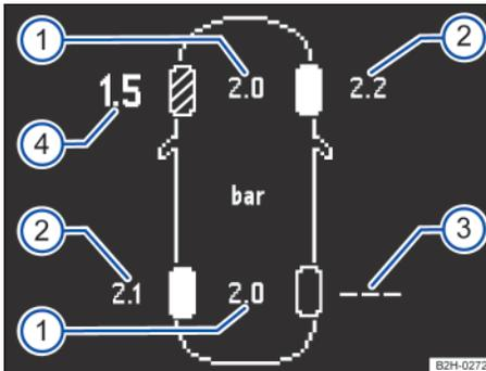
**Fig. 184** Representación esquemática de la visualización en la pantalla del cuadro de instrumentos: presiones actuales de los neumáticos.
