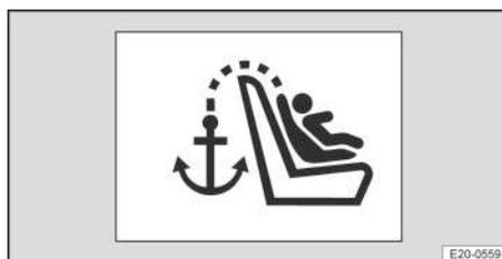
Fig. 42 Representación esquemática: distintivo del punto de fijación del cinturón Top Tether.
