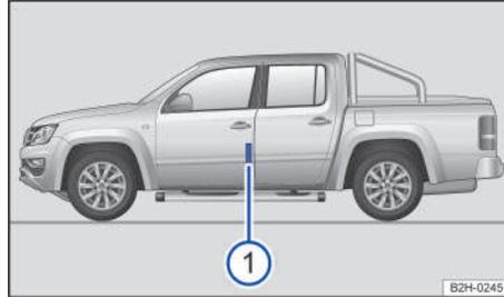
**Fig. 188** En el pilar de la puerta del conductor ①: adhesivo de la presión de los neumáticos (o en la cara interior de la tapa del depósito de combustible).
