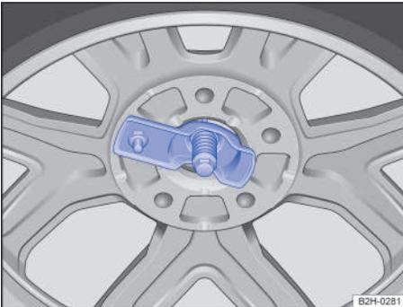
**Fig. 200** Rueda de repuesto o de emergencia: colocación correcta del soporte para llantas en el orificio de la llanta.
