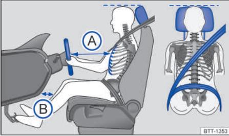
**Fig. 17** Representación esquemática: distancia correcta entre el conductor y el volante, colocación correcta de la banda del cinturón y ajuste correcto del apoyacabezas.
