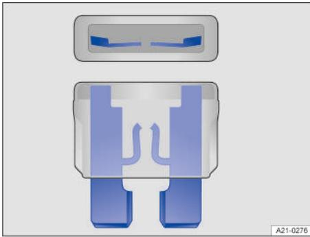
Fig. 161 Fusible fundido (representación esquemática).
