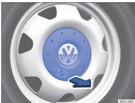
Fig. 191 Desmontar el tapacubos central tirando de él.
