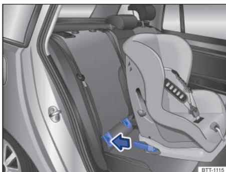
Fig. 41 Representación esquemática: montar el asiento para niños ISO-FIX con conectores.
