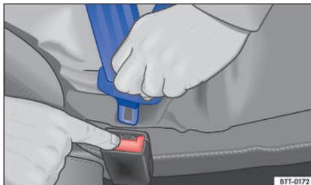
Fig. 20 Soltar la lengüeta del cierre del cinturón.
