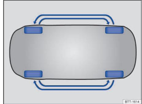
Fig. 186 Esquema para el intercambio de las ruedas.
