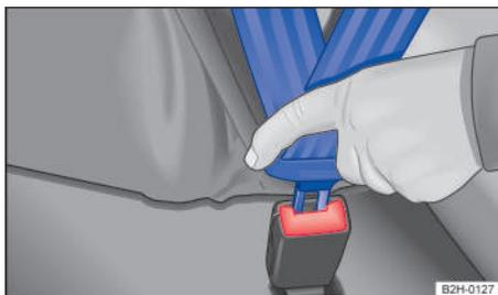
**Fig. 21** Insertar la lengüeta del cinturón de seguridad en su cierre.
