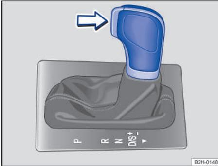
**Fig. 93** Vehículos con el volante a la izquierda: palanca selectora del cambio automático con tecla de bloqueo (flecha). En los vehículos con el volante a la derecha, la disposición es simétrica.
