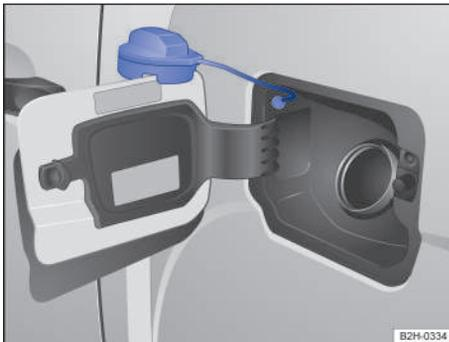
**Fig. 133** En el lado izquierdo del vehículo: tapa del depósito de combustible con el tapón abierto.
