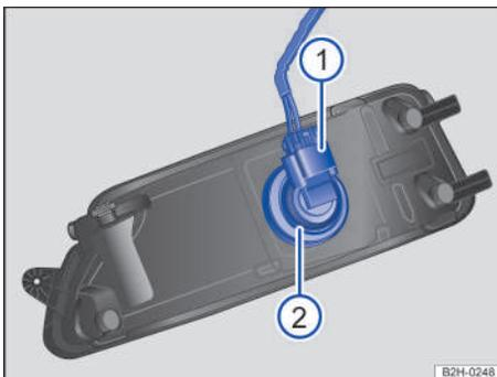
Fig. 149 Cambiar la lámpara del faro.
