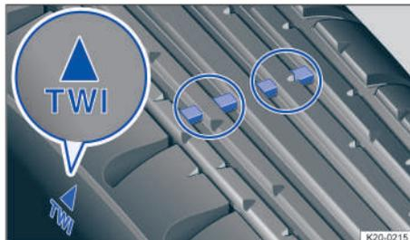
**Fig. 189** Perfil del neumático: indicadores de desgaste.
