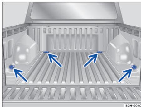
Fig. 129 En la superficie de carga: argollas de amarre.
