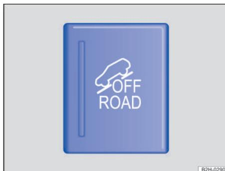
**Fig. 98** En la consola central: tecla para conectar y desconectar manualmente la función Offroad.
