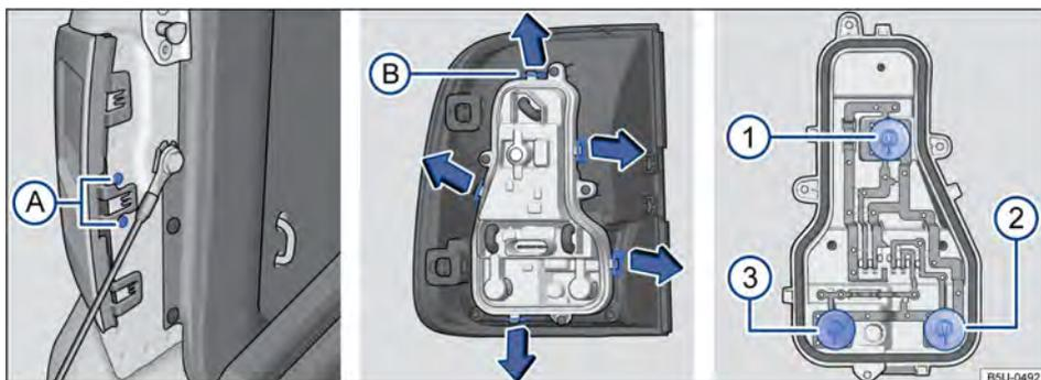
Fig. 138 Luz trasera: C desmontar el portalámparas y ①, ②, ③, ④ y ⑤ desmontar las bombillas.
