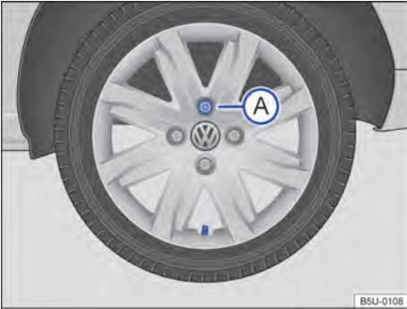
**Fig. 173** Cambio de rueda: secuencia de desmontaje de los tornillos de la rueda.
