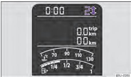
Fig. 79 En el panel de instrumentos: indicador de cambio de marcha (variante 1).
