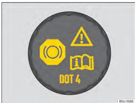
Fig. 158 En el compartimento del motor: tapón de cierre del depósito del líquido de frenos.
