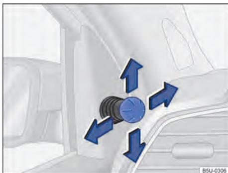
**Fig. 71** En las puertas delanteras: interruptor de ajuste de los espejos retrovisores externos mecánicos.
