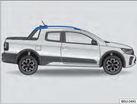
Fig. 123 Soportes longitudinales del maleteros de techo (ambos lados).
