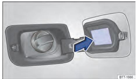
Fig. 163 En la parte interior de la portezuela del depósito de combustible: etiqueta con la presión de los neumáticos.
