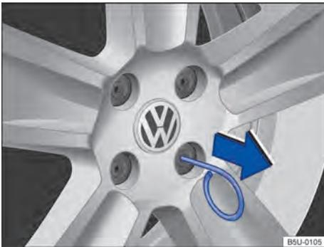
Fig. 168 Retirar las caperuzas de los tornillos de rueda.
