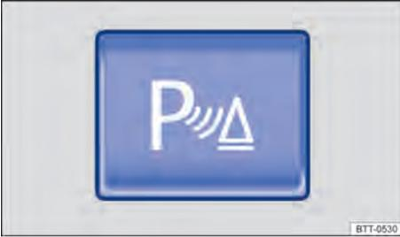
**Fig. 89** En la parte superior de la consola central: pulsador para activar y desactivar el control de distancia de aparcamiento (Park Pilot).
