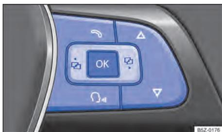
**Fig. 18** Lado derecho del volante multifunción: teclas de mando de los menús del panel de instrumentos.
