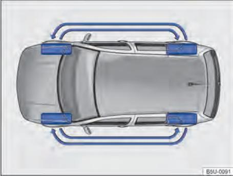
**Fig. 161** Esquema para cambio de las ruedas.
