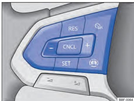
Fig. 100 Lado izquierdo del volante multifunción (variante 2): teclas para controlar el limitador de velocidad.
