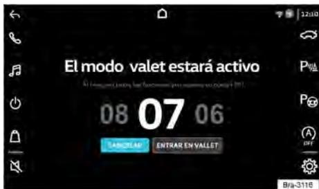
Fig. 155 Activación del modo de valet automático.
