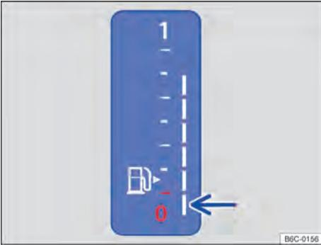
Fig. 11 En el instrumento combinado digital: indicador del nivel de combustible (variante 1).
