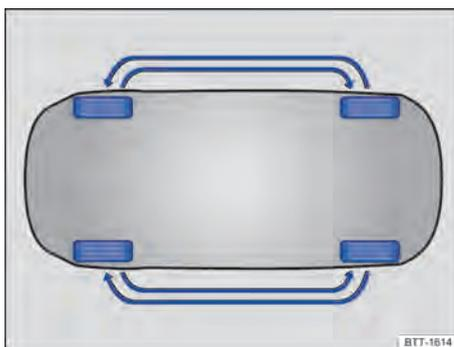
**Fig. 191** Esquema para cambio de las ruedas.
