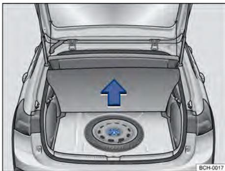
**Fig. 161** En el maletero, por debajo del revestimiento del piso: rueda de emergencia y herramientas de a bordo.
