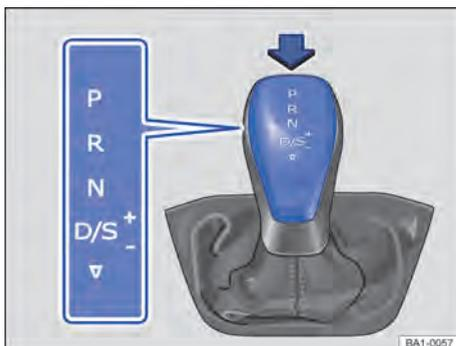
Fig. 93 Palanca selectora de la transmisión automática con tecla de bloqueo (flecha).
