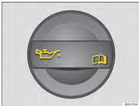
Fig. 185 En el compartimento del motor: tapón de la boca de llenado del aceite del motor.
