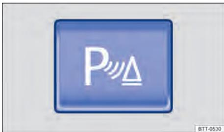
**Fig. 107** En la consola central o en la pantalla de la radio: tecla para encender y apagar la ayuda de aparcamiento (dependiendo del equipamiento del vehículo).
