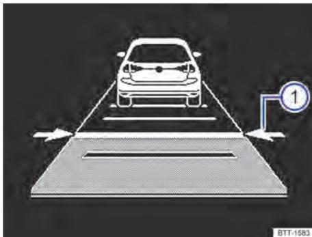
**Fig. 105** En la pantalla del cuadro de instrumentos: ajustar la distancia (representación esquemática, el ACC regula).
