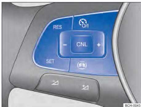
Fig. 99 Lado izquierdo del volante multifunción (variante 1): teclas para controlar el limitador de velocidad.
