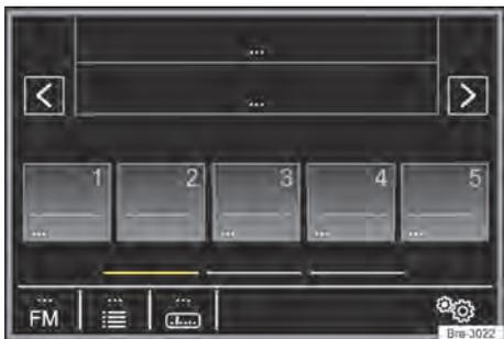
Fig. 131 Operación de la radio: búsqueda automática activada (SCAN).
