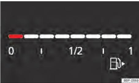
Fig. 12 En el instrumento combinado digital: indicador del nivel de combustible (variante 2).
