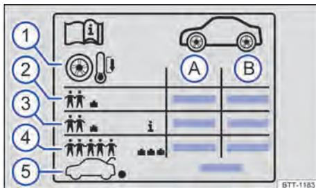
Fig. 192 Etiqueta con las presiones de los neumáticos
