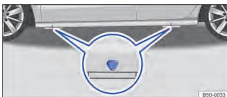
Fig. 198 Puntos de apoyo del gato.
