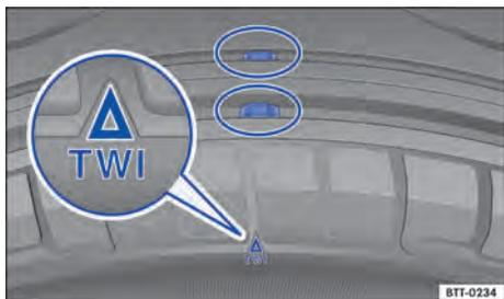
Fig. 194 Perfil del neumático: indicadores de desgaste.
