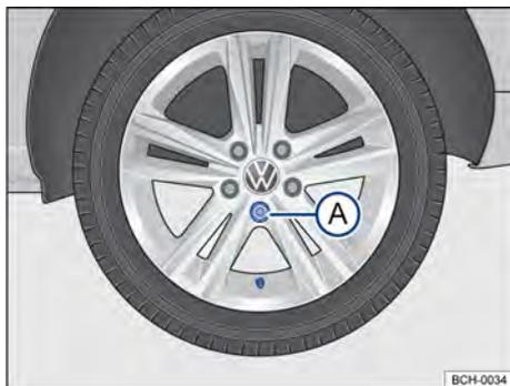
**Fig. 200** Cambio de rueda: secuencia de desmontaje de los tornillos de la rueda.
