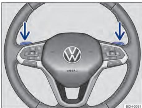
Fig. 95 Volante con selectores basculantes de Tiptronic.
