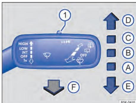
Fig. 74 A la derecha de la columna de dirección: comandar los limpiacristales.
