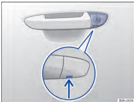
Fig. 53 Manilla de la puerta del conductor: bombín de cierre cubierto.
