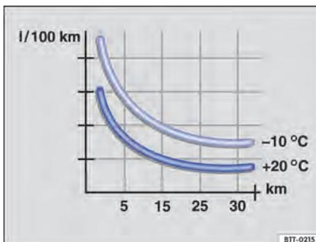
Fig. 87 Consumo de combustible en l/100 km en 2 temperaturas ambiente diferentes.
