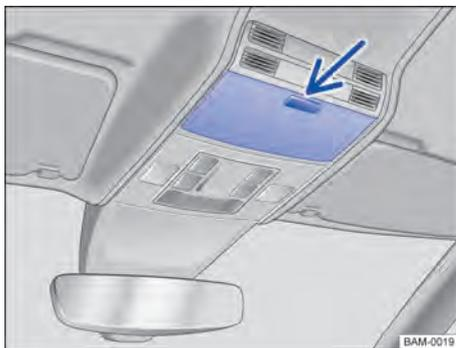
Fig. 114 En la consola del techo: porta anteojos.
