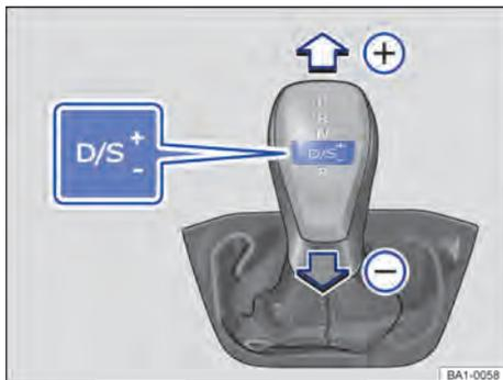
Fig. 94 Palanca selectora en la posición Tiptronic.
