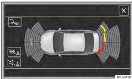
**Fig. 108** Indicación no sistema de radio: modo pantalla completo. Las áreas registradas dependen de la versión del vehículo.
