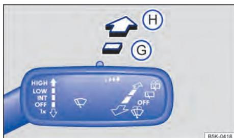
Fig. 75 A la derecha de la columna de dirección: comandar el limpiacristal.
