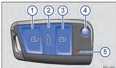
Fig. 47 Llave del vehículo con comando remoto.
