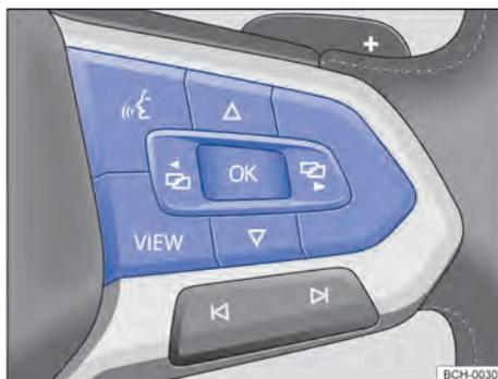
Fig. 17 Lado derecho del volante multifunción (variante 2): teclas para el mando de los menús y visualizaciones de información del instrumento combinado.
